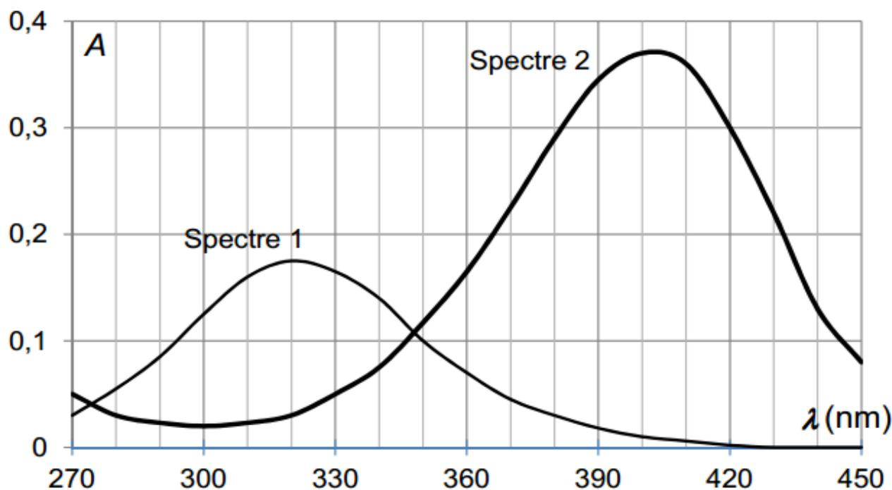
**Spectre 1 :** solution aqueuse de paranitrophénol de concentration molaire  $2,0 \times 10^{-5} \text{ mol.L}^{-1}$  en milieu acide ( $\text{pH} = 5$ ).
